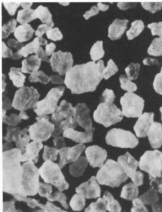
Fig. 9. — Materiale ricavato da zone a corrosione alta ( \times 30 ).
