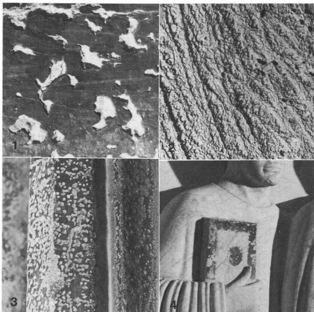
Fig. 1. — (1) Patina ad ossalato di calcio su « marmo di S. Giuliano ». Unitamente alla consistenza cornea è caratteristico l'aspetto liscio e lucente della superficie. Macrofotografia 8 x. Lucca - Chiesa di S. Giovanni, XII sec. (2) Patina ad ossalato di calcio a superficie granulosa. I solchi sub-paralleli sottolineano la lavorazione del marmo sottostante. Macrofotografia 8 x. Roma - Colonna Antonia (176 d.C.). (3) Cariatura delle patine ad ossalato di calcio nelle zone in cui prevale l'alterazione da condensa. Pilastro in « marmo di S. Giuliano ». Macrofotografia 1 x. Lucca - Chiesa di S. Giovanni. (4) Nel frontespizio del libro la patina bruna ad ossalato di calcio, marca la zona di probabile doratura del riquadro ai bordi e dell'ovale al centro. Lucca - Duomo di S. Martino (XIII sec.).
