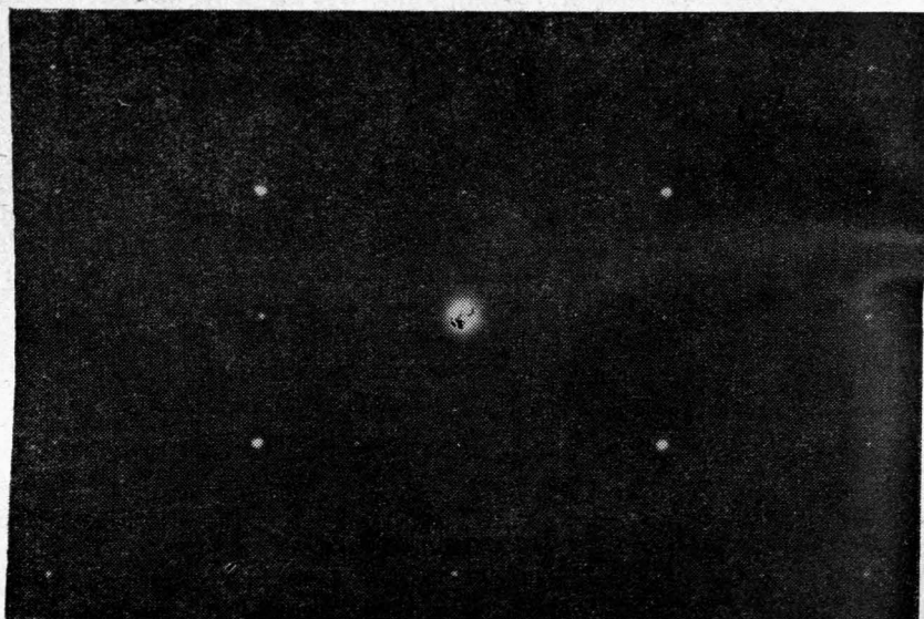
Рис. 2. Электронно-дифракционный снимок от кристалла тиннункулита. Направление первичного пучка \perp \{001\} .
