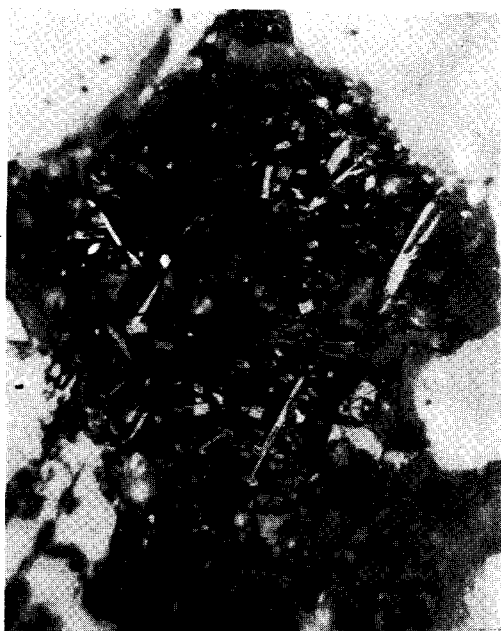
FIG. 3. — Inclusions aciculaires de stibine dans le minéral amorphe de formule \text{Tl}(\text{As}, \text{Sb})_{10}\text{S}_{16} . Section polie, lumière polarisée, 220\times , immersion.
