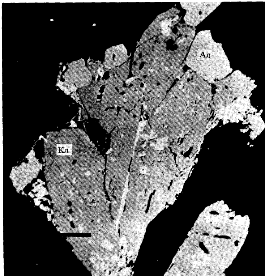
Рис. 1. Аларсит (изометричные светло-серые выделения) в сростании с ключевским (удлиненные темно-серые выделения). Микроанализатор "Самбах", 170х.
