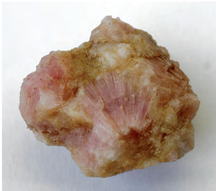
**Рис. 1.** Сноповидный агрегат розовых кристаллов, представляющих собой эпитаксические сростки авдеевита и берилла. Голотипный образец из Кат Чей, Мьянма. Размер образца 3.8 см.
