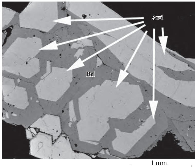
**Рис. 2.** Эпитаксическое срастание авдеевита (Avd) и берилла (BrI). Полированный срез соответствует грани {0001} обоих минералов. Изображение в отраженных электронах.
