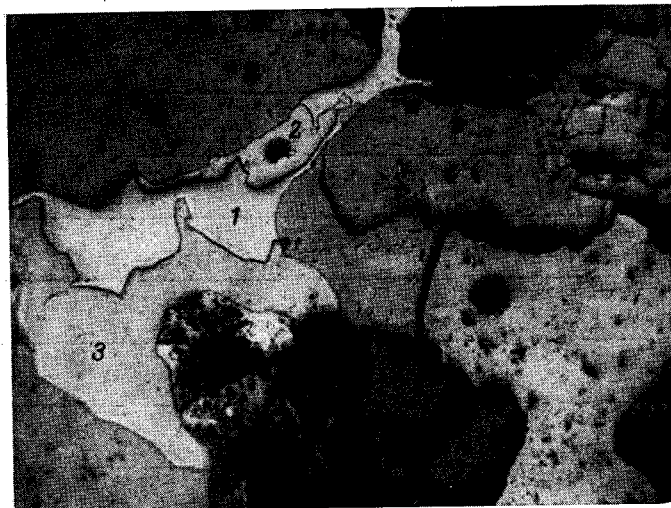
Рис. 1. Минерал PdBi (1) и находящиеся с ним в сростании сперрилит (2) и паоловит (3) нарастают на магнетит (черное и темно-серое). Основная серая масса — талнахит. Полир. шлиф. Увел. 90. Октябрьское месторождение, скв. КЗ-583.
