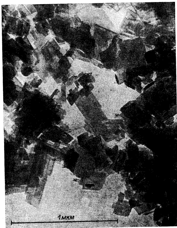
Рис. 1. Вид кристаллов сергеевита под электронным микроскопом. Увел. 20000.
