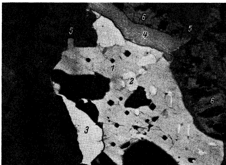
Рис. 1. Сросток паларстанида (1), (Pd, Pt)_3Sn (2), ферроплатины (3) и полярита (4) в массе кубанита (5) и пентландита (6). Увел. 200.
