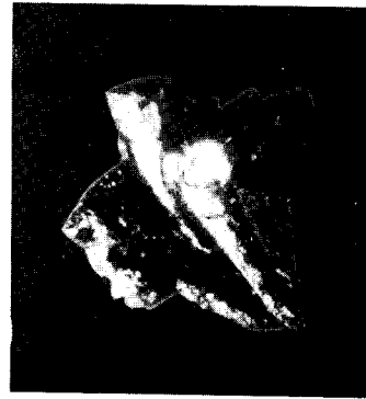
Рис. 4. Сросток кристаллов высокоцита. (Увел. 100).
