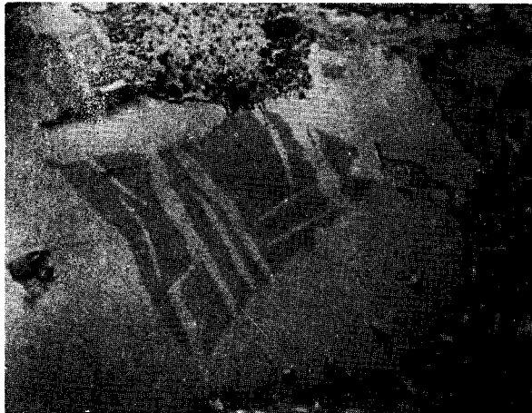
Рис. 8. Выделение линнеита (серое в центре снимка) в миллерите (белое) содержит пластинки миллерита. Рельефные выделения справа и сверху снимка — никелистый пирит. (Полированный шлиф, снято с иммерсией; увел. 380).
