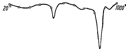
Рис. 5. Термограмма смеси хлорита, сибирскита, кальцита.
