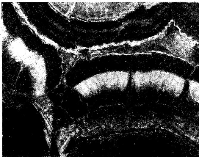
Рис. 10. Зерна индита и замещающего его джалиндита располагаются по трещинкам в касситерите. (Полированный шлиф, снято в косом свете).
