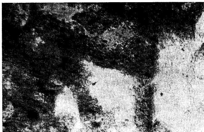
Рис. 3. Выделение татарскита неправильной формы (белое) в ангидритовой породе. (Микрофотография, увел. 36; без анализатора).
