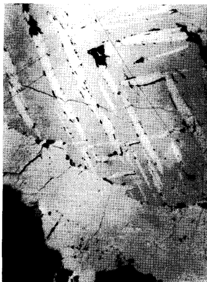
FIG. 1. — Hocartite (en haut), légèrement plus foncée que la stannite qui l'englobe (à droite) et s'associe avec elle en lamelles orientées, LN \times 200, immersion dans l'huile.
