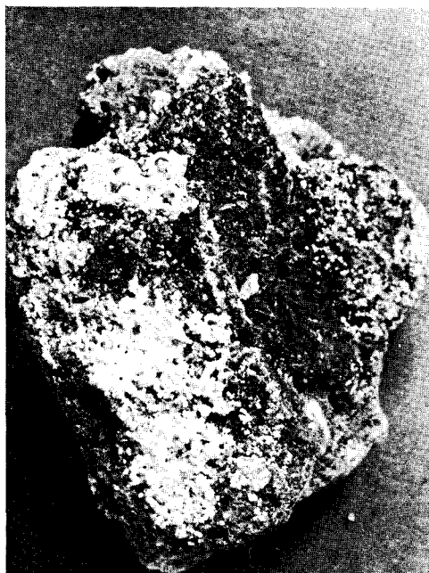
FIG. 1. — Agrégats de kanemite (blanche) englobés dans la masse de trona ; 2 ×.
