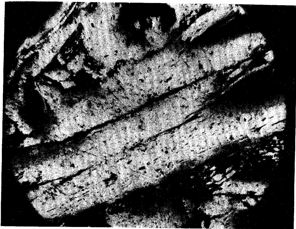
Figura 1. Paraguanajuatita de Guanajuato. Plano pulido mostrando bien el cruceo original de la guanajuatita, y localmente también la estructura radiada, pero con muy poco pleocroísmo de reflexión.
