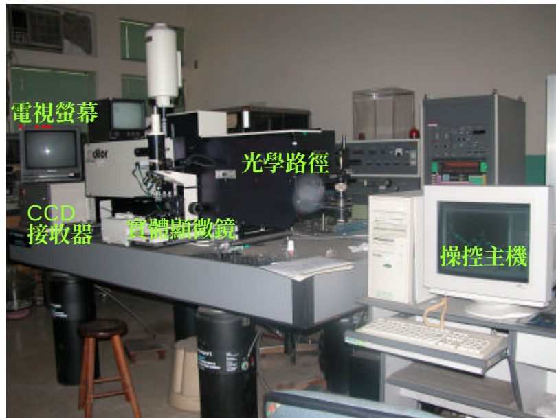
圖 2-2.3 拉曼儀器圖（反面）。標本放於顯微鏡上，配合電視螢幕上顯現標本之影像，調整最理想焦距。之後操作電腦主機，即可進行分析實驗。
