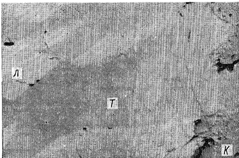
Рис. 1. Выделение литиотантита (Л) в краевой части торолита (Т) (К — касситерит). Отраженный, поляризованный свет, ув. 240.
