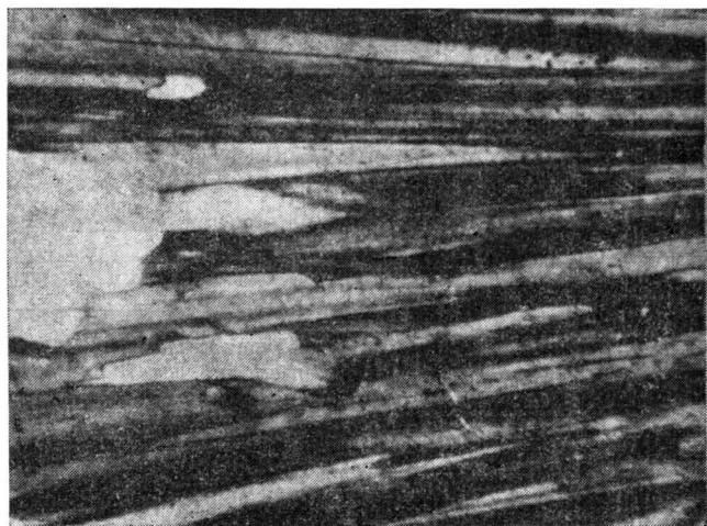
Рис. 1. Форма зерен токкоита, видна одновременность в наступлении состояния погасания Николи+, ув. 100.
